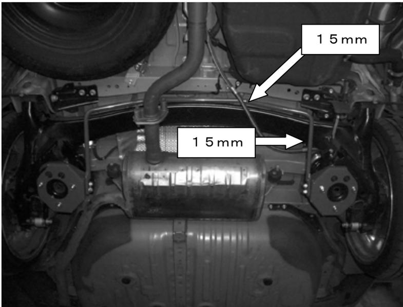
④ バーの各部のクリアランスが15mm以上になる様に調整し、ボルト、ナットを締付けて下さい。
