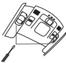
②電球・反射板の取り外し
