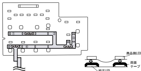
※LEDを両面テープで貼り付けした際、LED間のフィルムはたわむ設計になっています。
