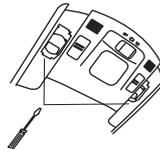
電球を取り外します。反射板を固定しているツメをマイナスドライバーで押して外します。
