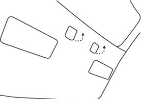
ナンバーランプ付近の内張りを外せる様になっていますので、下側から内張り剥し等を差し込み、内張りを剥がします。
