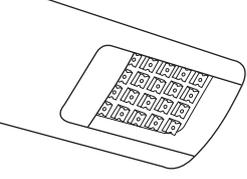
LEDが固定できましたら、LEDの向きや、両面テープの接着の具合を確認し、点灯チェックを行ってください。(点灯しない場合は、再度、金具部の取り付け具合を確認してください。)確認できましたら、カバーを装着し完成です。全4箇所 同様の作業を行ってください。
