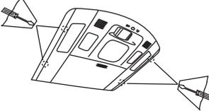
ランプが消えていることを確認し、ランプカバーの切り込みにマイナスドライバー等の細い工具で、軟らかい布を当て、取り外します。
