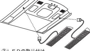
純正電球を取り外した、逆の要領で取り付けます。この時点で必ず、点灯チェックを行ってください。点灯しない場合は、電極部を差込を反対側に変えて取り付けを行ってください。LED本体の裏側の両面テープを剥がし、貼り付けます。
