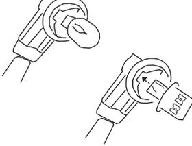
ソケットから、純正電球を取り外し、LEDを取り付けます。ここで必ず点灯確認を行ってください。点灯が確認できたら、ソケットをナンバーランプ本体に取り付けます。
