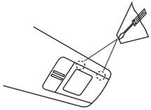
ランプが消えていることを確認し、ランプカバーの隙間にマイナスドライバー等の細い工具に軟らかい布を当て、取り外します。
