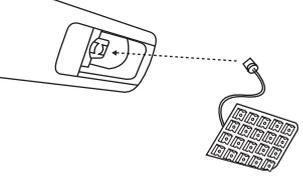
純正電球を取り外した、逆の要領で取り付けます。この時点で必ず、点灯チェックを行ってください。点灯しない場合は、電極部の差込を反対側に変えて取り付けを行ってください。LED本体の裏側の両面テープを剥がし、貼り付けます。
