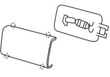
丸印部のツメを外しカバーを取り外し電球を取り外します。
