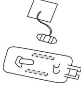
純正電球を取り外した、逆の要領で取り付けます。この時点で必ず、点灯チェックを行ってください。点灯しない場合は、電極部の差込を反対側に変えて取り付けを行ってください。LED本体の両面テープを剥がし、レンズへ貼り付けます。
