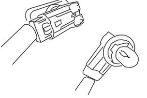
内張りを剥がすとナンバーランプのソケットが見えてきますので、ソケットを取り外します。
