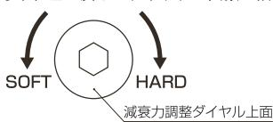
**△ 注意** 締めきり(0段)での使用は破損の原因となりますので、使用しないでください。減衰力は1～40段の範囲で調整出来ます。構造上40段以上に戻りますが、破損の原因となりますので必ず1～40段の範囲で調整してください。
